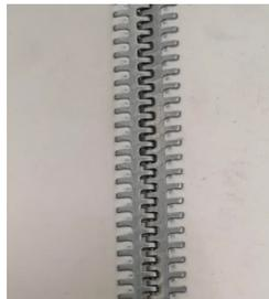
Este tipo de empalme implica un aumento de 50% en el diámetro mínimo de polea. Las uniones metálicas pueden ser en acero inoxidable y antimagnético. La grapa puede ser tipo clipper o alligator.
